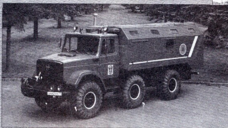
ЗИЛ-497205 оснащен двухрядной семиместной кабиной, поворотным краном-манипулятором и грузовой платформой, в которой размещены контейнеры со спасательным оборудованием
